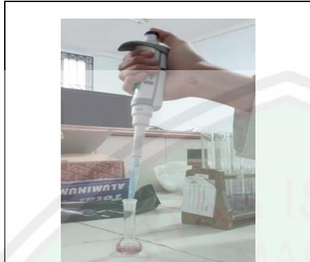
Memasukkan sampel dan DPPH dalam labu ukur menggunakan mikropipet
