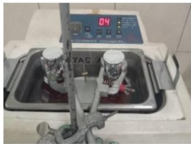
Ekstraksi bekatul 30 gram dalam pelarut etanol 180 mL menggunakan metode sonikasi selama 20 menit
