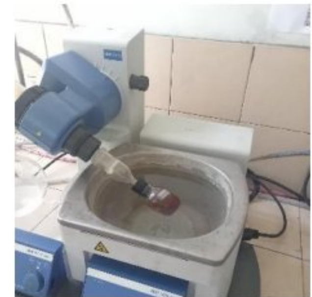
Penguapan pelarut menggunakan vacum rotary evaporator pada suhu 45 °C
