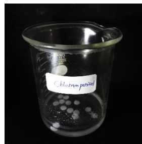
Gambar 9. Proses perendaman paper disk selama 15 menit, (a) dalam larutan chloramphenicol dan (b) dalam tween 80
