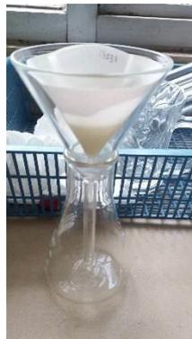
Gambar 17. Filtrat ekstrak anting-anting setelah ditetesi  $\text{NH}_4\text{OH}$
