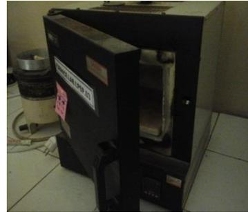
Gambar 25. Cawan berisi sampel ditanur pada  $T 600 \pm 25 \text{ } ^\circ\text{C}$  selama 30 menit
