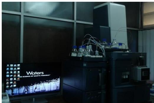
Gambar 19. Seperangkat peralatan UPLC with DAD *detector* yang tersambung dengan spektroskopi massa Xevo G2-S Qtof (Waters)
