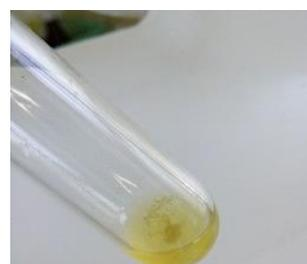
Gambar 15. Uji alkaloid dengan reagen Meyer
