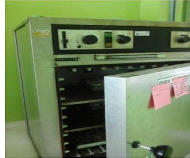
Gambar 21. Cawan berisi sampel dioven pada  $T 105^{\circ}\text{C}$  selama  $\pm 15$  menit
