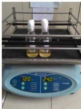
Prproses inkubasi pembuatan inokulum dalam SDB dengan shaker pada suhu ruang
