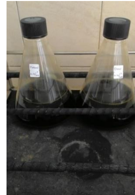
Proses maserasi daun plethekan dengan pelarut etanol
