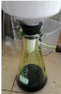
Proses penyaringan ekstrak hasil maserasi dengan pompa vakum
