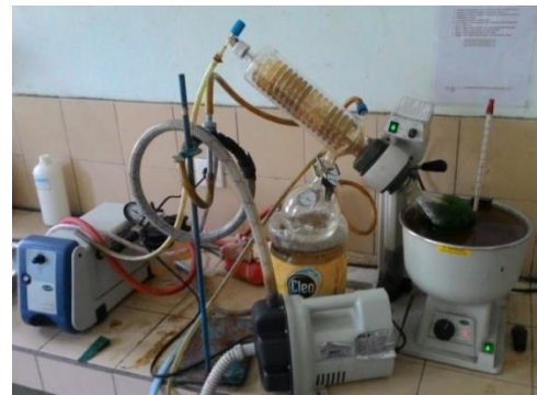
Proses pemisahan ekstrak dengan pelarutnya menggunakan rotary evaporator vakum
