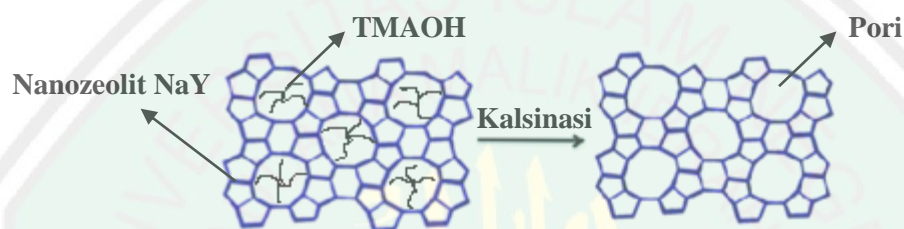
Gambar 4.1 Pembentukan nanozeolit NaY dengan templat TMAOH
