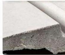
Material atap menggunakan glass fiber reinforced polymer atau GFRP
