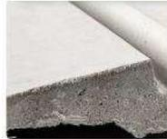
Material atap menggunakan glass fiber reinforced polymer atau GFRP
