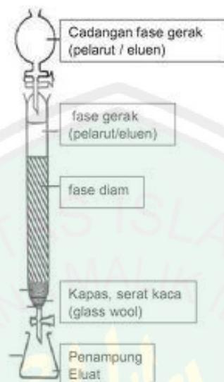
Gambar 2. Bagian-Bagian Kromatografi Kolom Cara Kering
