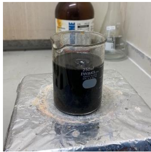
Gambar L.9.3 Destruksi limbah dengan 100 mL HNO 3 5 M
