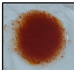
Gambar 4.2 Hasil reaksi prekursor ferri dengan \text{NaOH}
