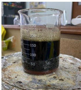
Gambar L.9.8 Campuran larutan prekursor dengan 100 mL ekstrak daun jambu biji
