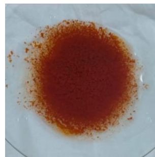
Gambar L.9.5 Endapan merah yang terbentuk saat uji keberadaan Fe 3+
