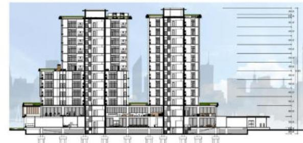
Rusun menggunakan Bentang 10m, dengan perhitungan kolom 1/10, sehingga mendapatkan ukuran kolom 1x1m
