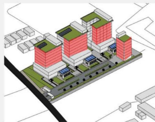
Menambahkan balkon dan fasad pada bangunan unit, dan pada podium menggunakan tipe bukaan kaca pada sisi utara-selatan dan dilapisi secondary skin pada sisi timur-barat
