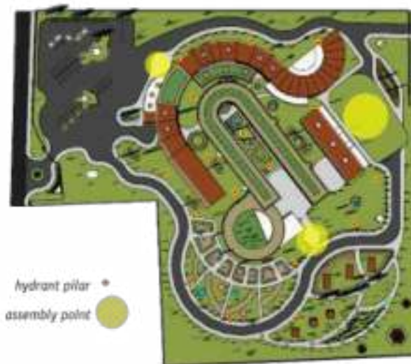
Gambar 4. 69 Analisis Utilitas (Instalasi Kebakaran) (Sumber: Analisis Pribadi)
