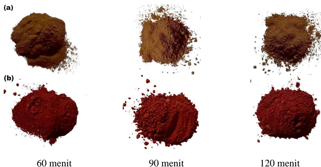
Gambar 4.5 Hasil sintesis pigmen hematit dengan variasi waktu sintesis 60, 90 dan 120 menit: (a) sebelum dikalsinasi dan (b) sesudah dikalsinasi
