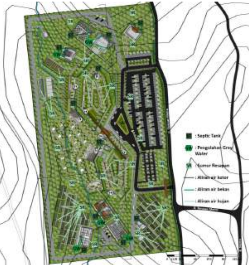
Gambar 6.27 Konsep Sistem Bangunan dan Utilitas
