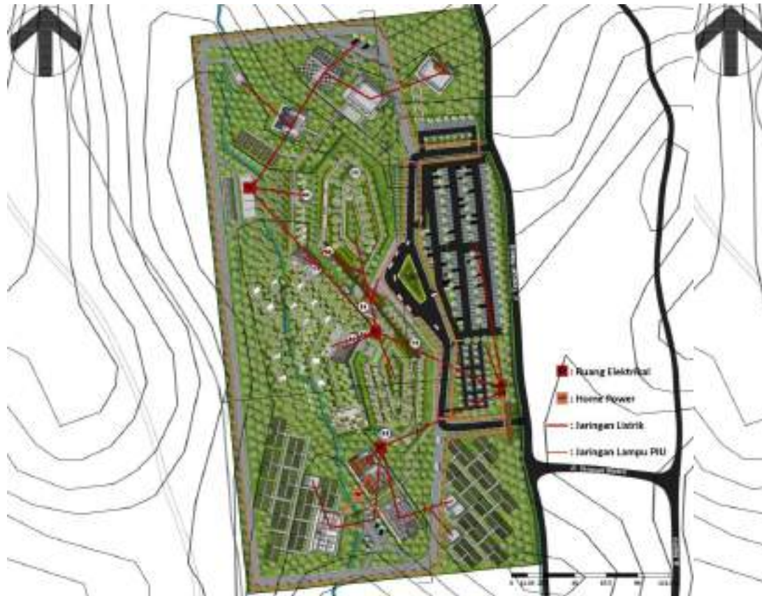
Gambar 6.28 Konsep Sistem Bangunan dan Utilitas
