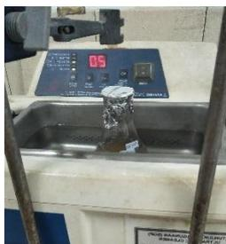
Gambar 4. Dilakukan Ekstraksi Sonikasi dari masing-masing elenmeyer
