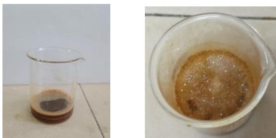
Gambar 4. 3 Terbentuknya Gas CO 2 pada proses hidrolisis
