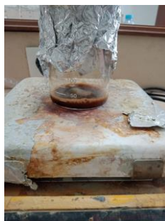
Proses shaker ekstrak pekat etanol 70% selama 1 jam
