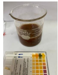
Pengecekan pH setelah penambahan \text{NaHCO}_3
