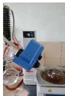
Pemekatan dengan rotary evaporator vacuum
