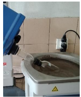
Pemekatan fraksi etil asetat dengan rotary evaporator vacuum
