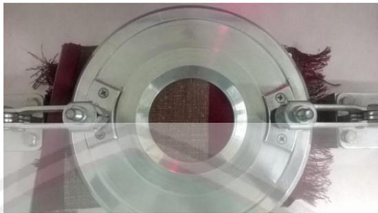
Gambar 4.8 Pemasangan kain untuk uji daya tembus udara kain
