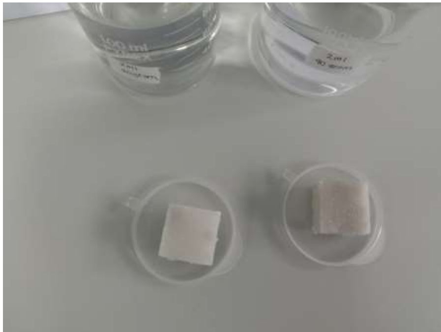
Penempatan material katalis pada sugar cube
