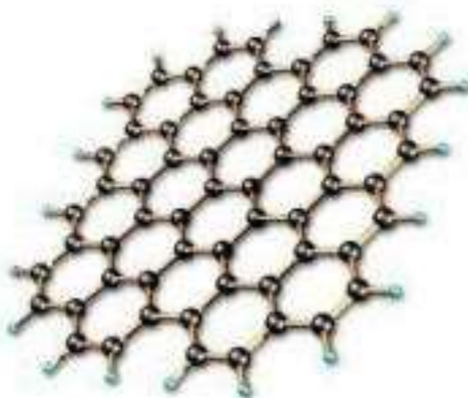
Gambar 2.5 Struktur grafena (Murtiaji, 2010)
