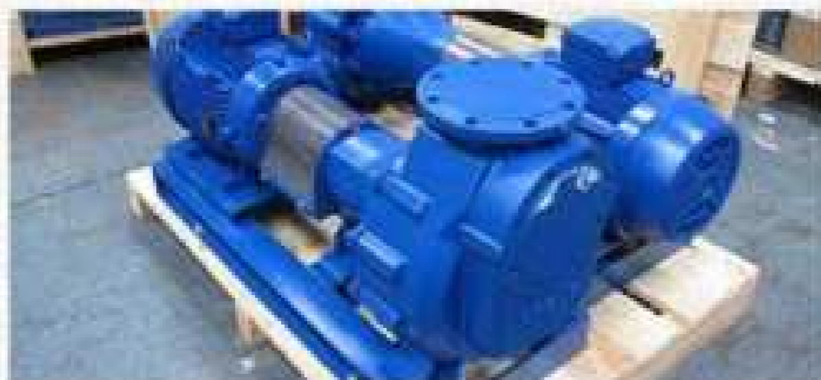
Mesin S.W Pump untuk memompa air laut ke area filtrasi
