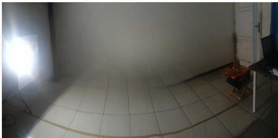
Gambar 4.7 Pengujian Sensor LDR Pada Jarak 3 Meter
