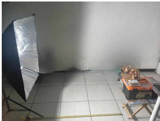
Gambar 4.5 Pengujian Sensor LDR pada Jarak Satu Meter
