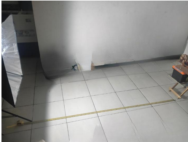
Gambar 4.6 Pengujian Sensor LDR pada Jarak Dua Meter
