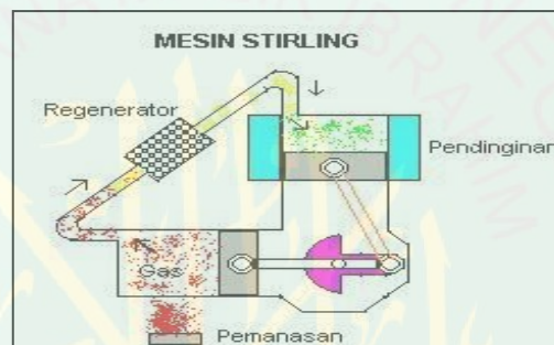
Gambar 2.2 Gambaran umum Mesin Stirling (Walker G: 1965)
