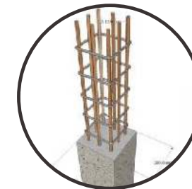
Struktur Rigid Frame dengan material beton bertulang
