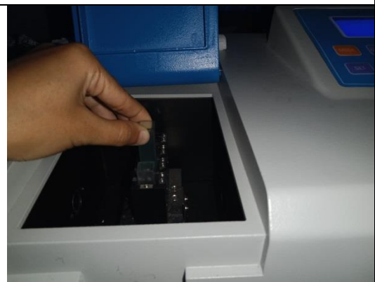
Gambar uji absorbansi sampel setelah proses fotokatalis menggunakan alat spektrofotometer.
