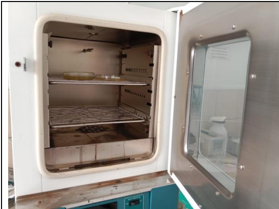
Gambar pengovenan CDs dengan suhu 90°C selama 24 jam untuk uji FTIR.
