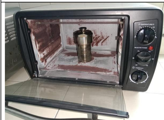
Gambar proses hidrotermal dengan variasi waktu dan temperatur hidrotermal 160°C, 180°C, 200°C selama 5 dan 7 jam.
