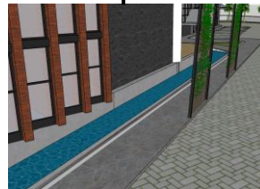
Penggunaan kolam air sebagai penampung air hujan dan juga sebagai penetralisir panas
