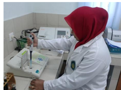
Uji kandungan klorofil daun Sawi Daging dengan metode Spektrofotometri
