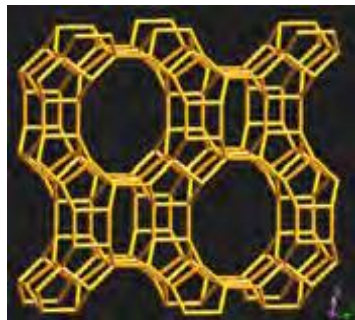
Gambar 2.1 Contoh struktur 3 dimensi zeolit alam (Utubira, dkk., 2006)
