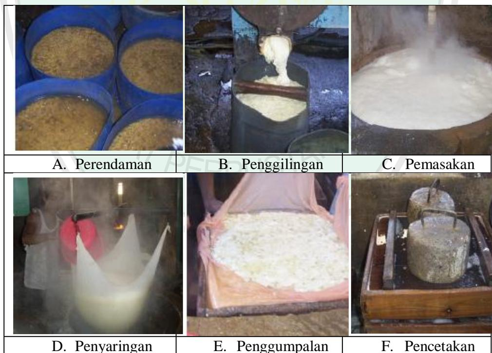
Gambar 2. Proses Pembuatan Tahu
