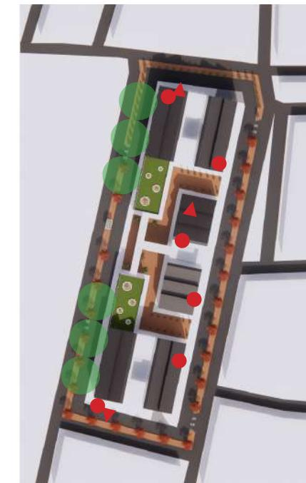
Gambar 4.75 Output Analisis Utilitas Sistem Kebakaran
