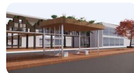
Penggunaan material untuk halte pada perancangan ulang Pasar Kebon Kembang Bogor adalah besi sebagai struktur dan alumunium composite panel sebagai penutup atap karena memiliki daya tahan yang baik terhadap perubahan cuaca dan kelembapan.
