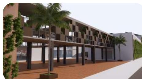
Sky bridge pada perancangan ulang Pasar Kebon Kembang Bogor menggunakan kombinasi material baja sebagai struktur untuk terlihat minimalis dan beton sebagai atap dan lantai sky bridge.
