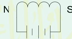
Gambar 2.11 Medan magnet yang ditimbulkan melalui pengisian muatan pada kumparan koil
