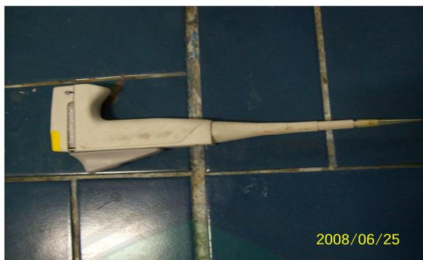
**Gambar 4. Mikropipet**
