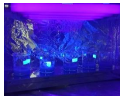
Fotodegradasi larutan NBB dengan sinar UV
