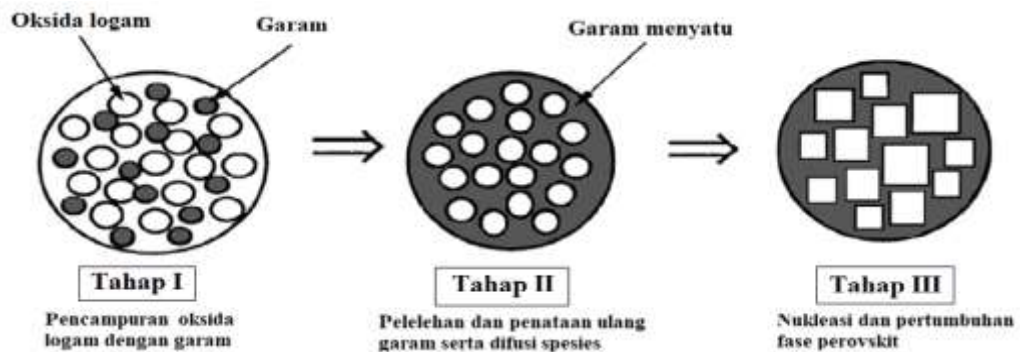
Gambar 2.11 Skema proses sintesis menggunakan metode lelehan garam (Xue, dkk., 2018)
