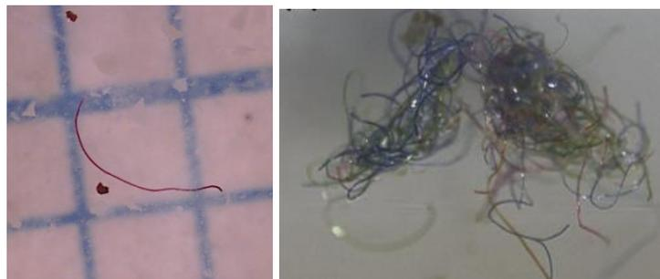
**Gambar 4.5. Mikroplastik tipe fiber.** (a) Hasil pengamatan dan (b) literatur (Free *et al.*, 2014)
