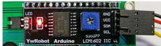
Gambar 2.8 Komunikasi 4 kabel I 2 C
