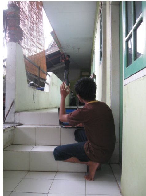
Gambar 8. Percobaan Pengukuran Pada Jarak 8 meter, Ketinggian 3 meter OK
