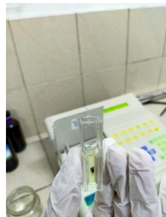
Pengukuran absorbansi menggunakan Spektrofotometri UV-Vis
