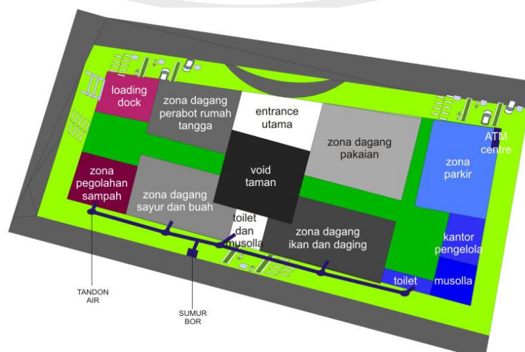
Gambar 4.32 Skema Distribusi Air Hujan pada Tapak Sumber : Hasil Analisa,2015
