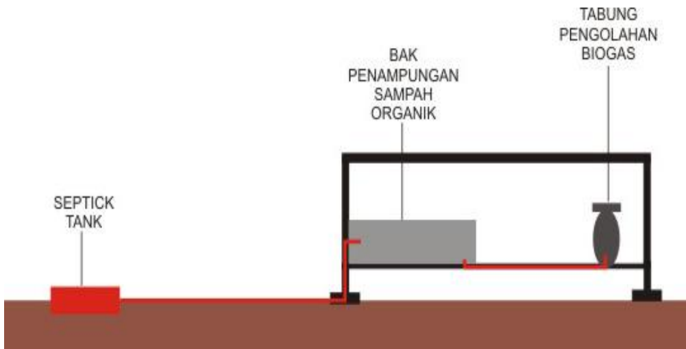
Gambar 4.53 Skema Sampah Organik Menjadi Biogas pada Bangunan Sumber : Hasil Analisa,2015
