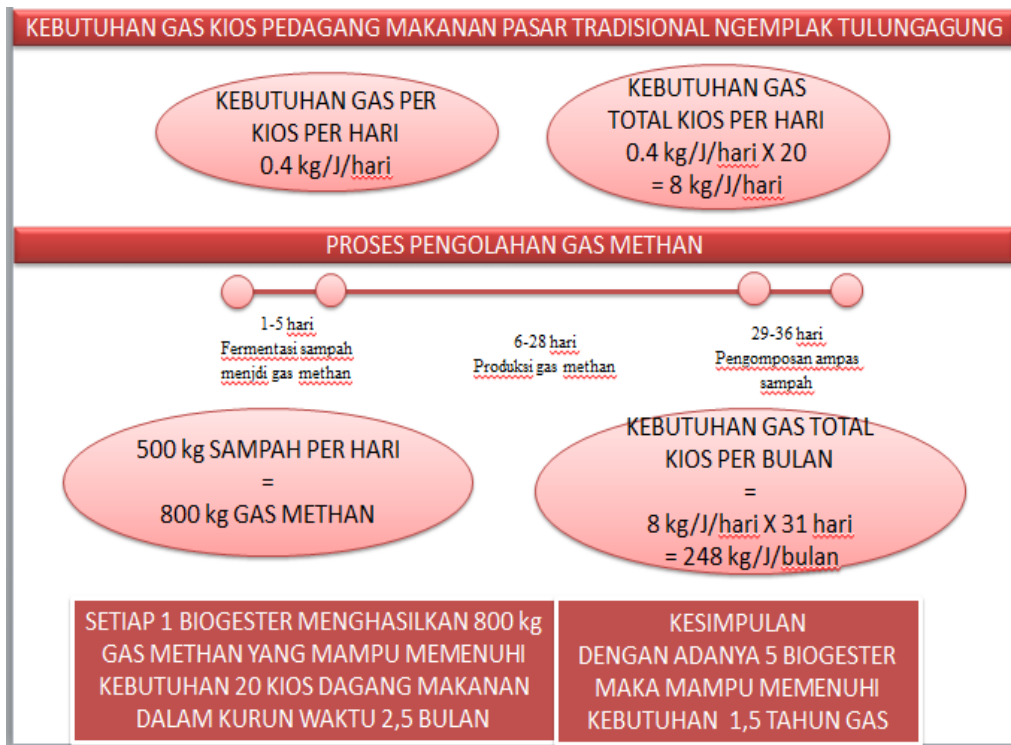
Gambar 6.15 Skema Perhitungan Gas Methan Sumber : Dokumen Hasil Rancangan 2016
