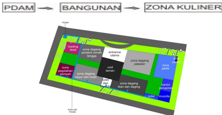
Gambar 4.28 Skema Distribusi Air PDAM pada Tapak Sumber : Hasil Analisa,2015
