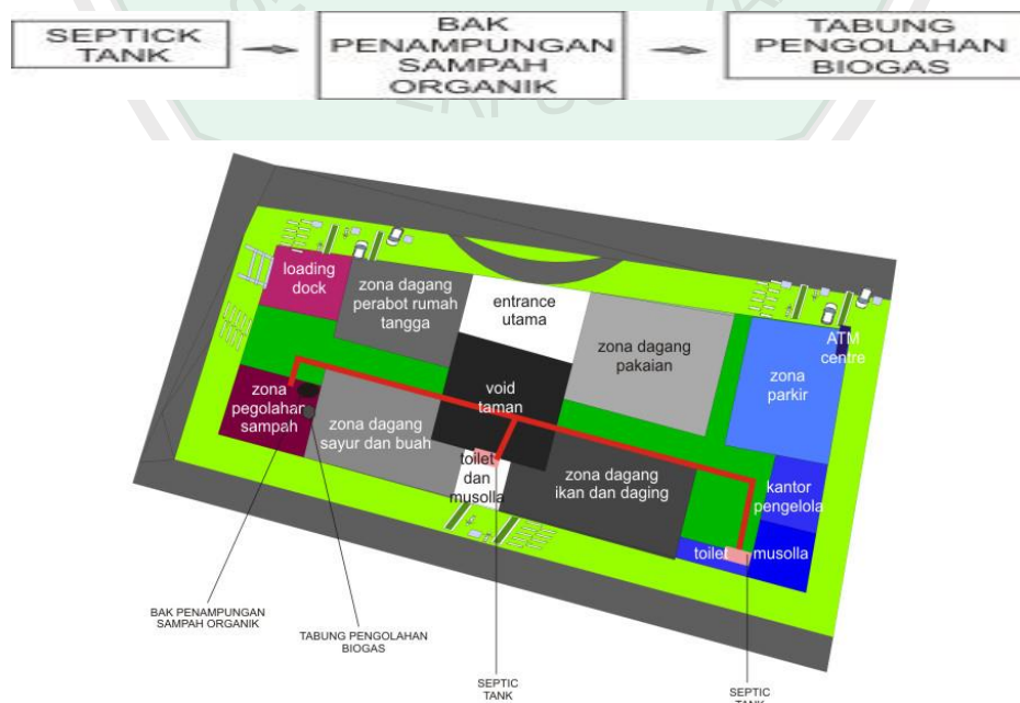
Gambar 4.52 Skema Sampah Organik Menjadi Biogas pada Tapak Sumber : Hasil Analisa,2015
