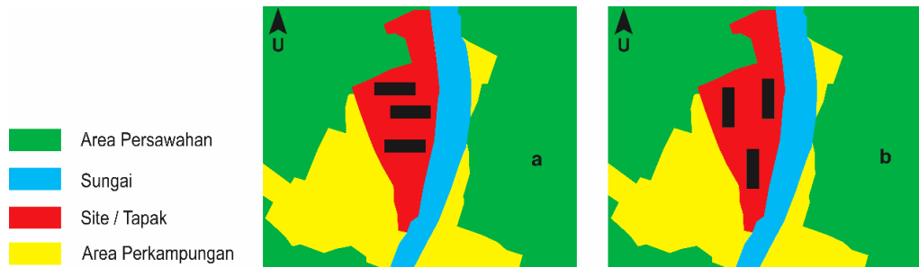
Gambar 2.29. Orientasi bangunan memanjang kearah timur- barat (a), dan tegak lurus terhadap arah angin (b) Sumber: Analisis 2015
