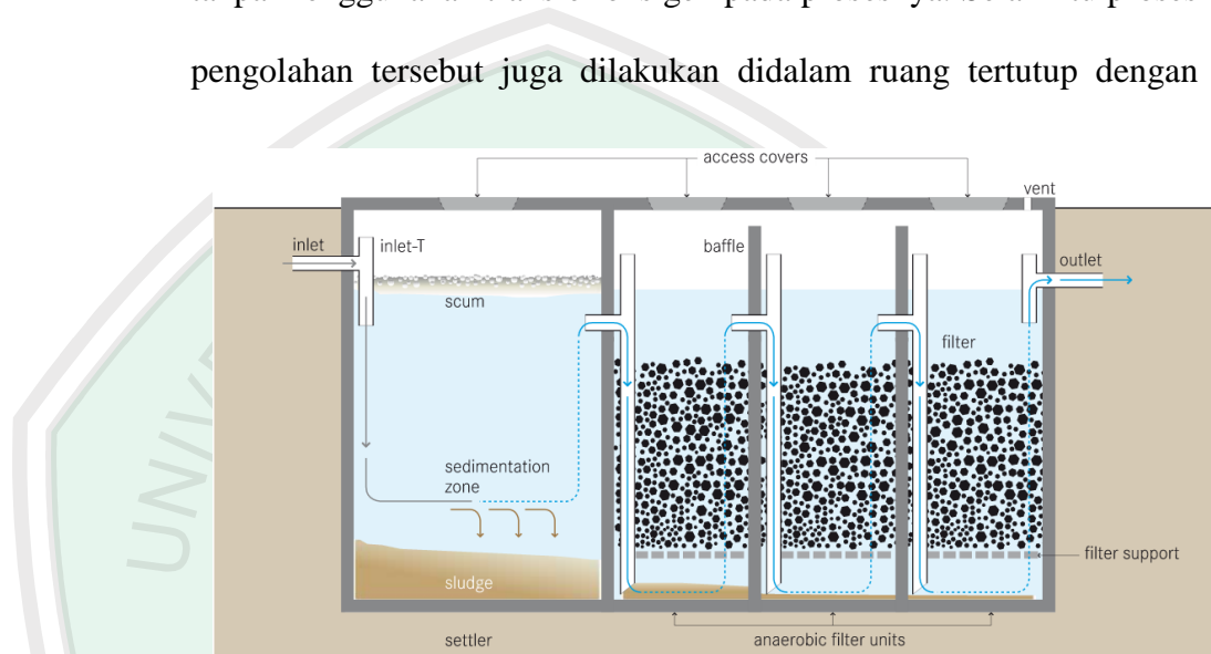
Gambar 4.73. Sistem IPAL anaerob (Sumber: google.co.id)
