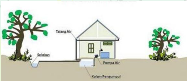
Gambar 2.32. Sistem rain water reservoir dengan kolam pengumpulan di bawah permukaan tanah Sumber: Taufiqurrahman (2012)
