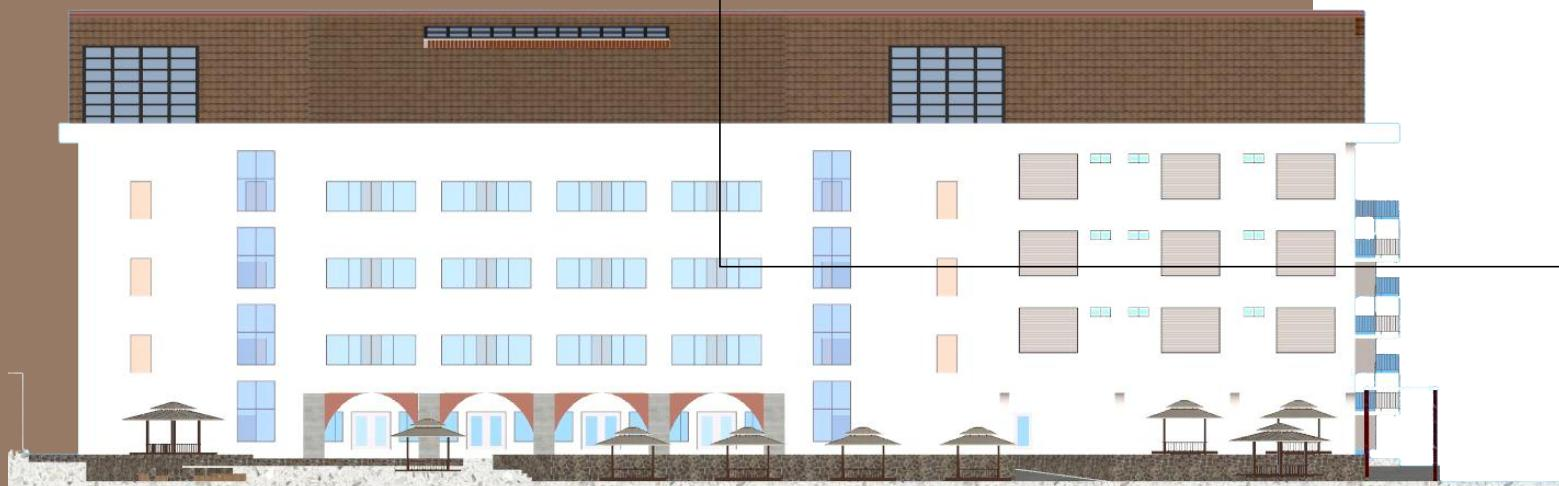
Selain dari bentuk, pemilihan material selubung bangunan juga memiliki peran untuk menciptakan bangunan yang resilient. Double skin bangunan yang bermaterial krawangan dan ACP dipilih untuk mengurangi beban dari massa bangunan itu sendiri. Dengan begitu, sistem pembebanan dalam bangunan dapat teringankan.
