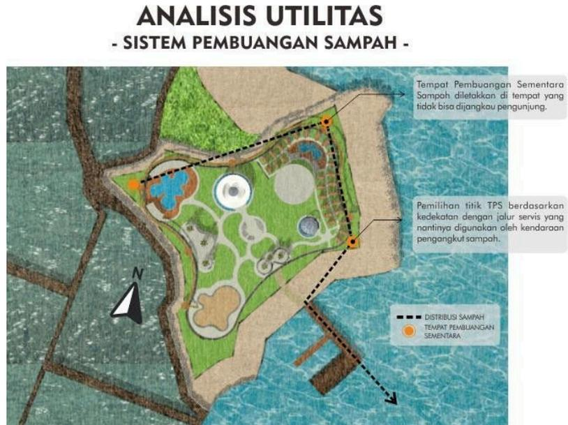
Gambar 4.45 Analisis Sistem Pembuangan Sampah
