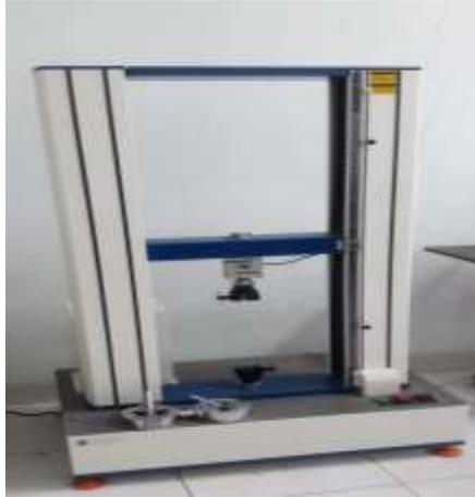
Untuk menguji kekuatan tarik dan perpanjangan putus jenis mie instan ini dilakukan dengan alat tensile tester tipe LY-1066 A yang berada di laboratorium fisika material.
