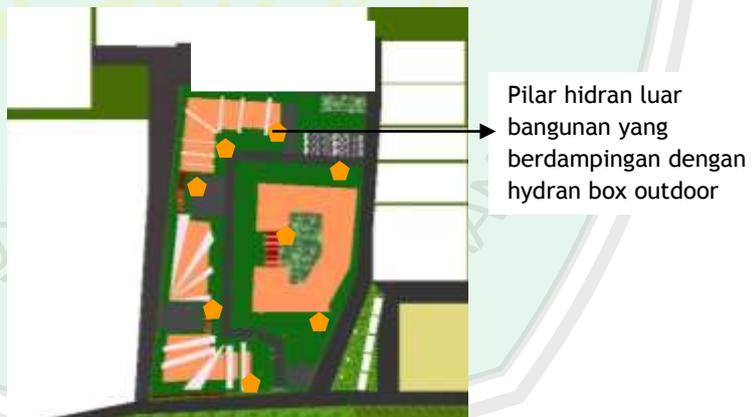
Gambar 5.11 titik pilar hidran
