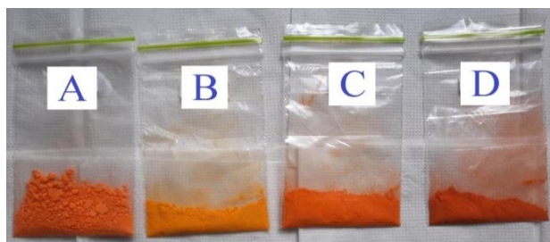
Gambar 4. 8 Hasil sintesis (a) basa Schiff, (b) kompleks 100°C, (c) kompleks 120°C, (d) kompleks 140°C
