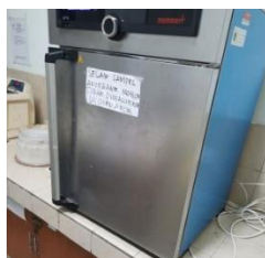
Dioven 12 jam variasi suhu 100^\circ\text{C} , 120^\circ\text{C} dan 140^\circ\text{C}
