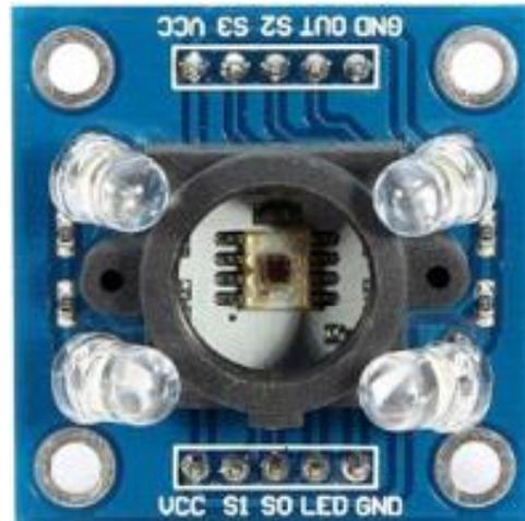
Gambar 2.1 Sensor Warna TCS3200
