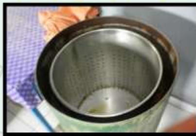
**Gambar 2.11 Alat pemisahan minyak dari keripik**
