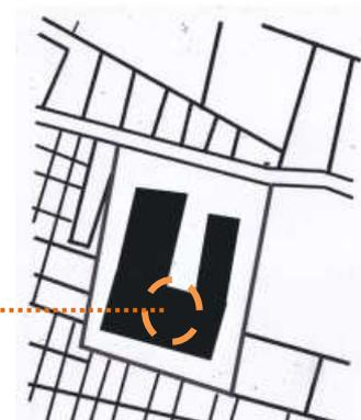
Bentuk dibuat terpusat di bagian tengah sebagai ikon bangunan utama. Bentuk juga menyesuaikan view yang ada pada sekitar tapak tapak serta menyesuaikan dengan pusat penyebaran air yang berada di tengah yang menyebar ke seluruh bangunan.
