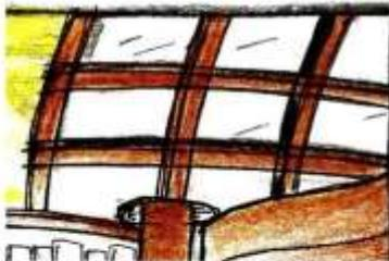
Struktur cangkang digunakan untuk membentuk kekuatan atas beban yang ditimbulkan pada bangunan terutama pada atap. Pada bagian bawah struktur nantinya akan diletakkan pipa-pipa sebagai saluran air yang disebarkan ke dalam ruangan untuk pendingin ruangan. Pipa yang diletakkan adalah transparan sehingga dapat pula digunakan sebagai pembentuk estetika dalam bangunan.
