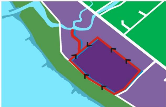
Pembuatan parit pada area sekeliling tapak, sebagai antisipasi tsunami, agar dapat dialirkan ke sungai dan tidak angsung mengenai bangunan
