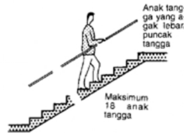
⑤ Ukuran tangga normal 17/29 Anak tangga yang agak lebar dibuat setelah maksimum 18 tingkat/anak tangga
