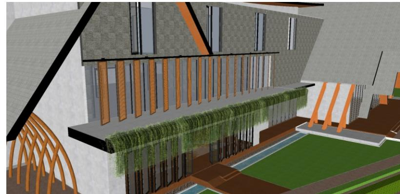
Material pada fasad menggunakan material alam seperti batu alam, kayu, dan tanaman untuk membuat bangunan terlihat lebih ekspresif serta kaca dan logam yang ditambahkan sebagai salah satu material modern dari konsep kontemporer
