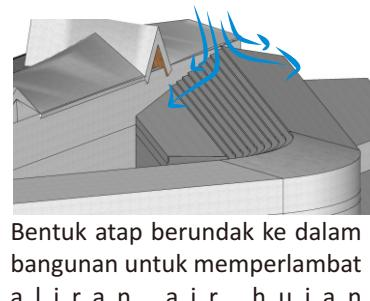
Bentuk atap berundak ke dalam bangunan untuk memperlambat aliran air hujan
