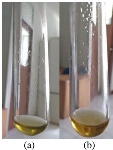
Gambar 4.2 Perubahan warna pada uji fitokimia flavonoid (a) sebelum penambahan bubuk Mg dan HCl pekat (b) sesudah penambahan bubuk mg dan HCl pekat.
