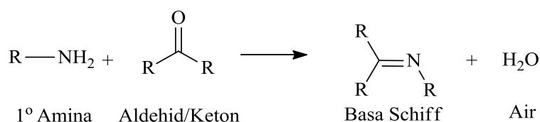
Gambar 2. 3 Reaksi pembentukan basa Schiff (Xavier & Srividhya, 2014)
