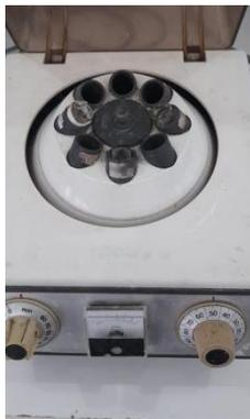
Tabung reaksi dimasukkan ke dalam *centrifuge*
