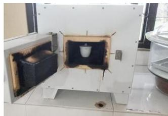
Krusible dimasukkan ke dalam *muffle furnace*
